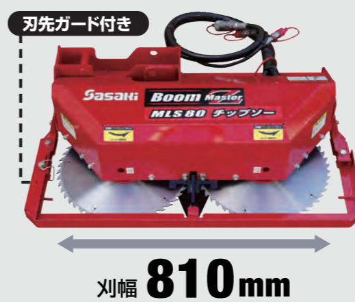
大型チップソー(φ405mm)を2枚装備。枝の最大刈取径は10cm。
