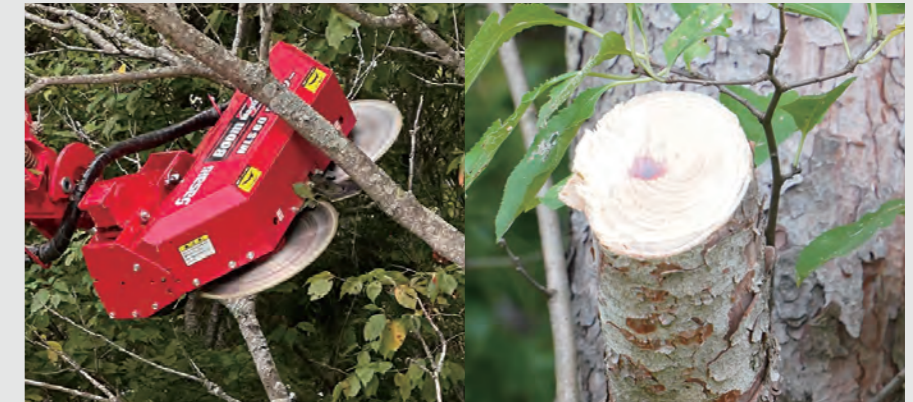
大型チップソー(φ405mm)を2枚装備。枝の最大刈取径は10cm。
