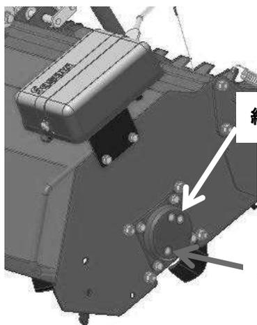
注油箇所は、折りたたみ支点とレール・ローラ、ユニバーサルジョイント、油圧シリンダです。
