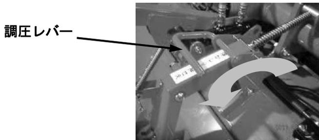
レベラー圧の軽減は、【調圧レバー】を『浮かし』の方へ切替えます。
