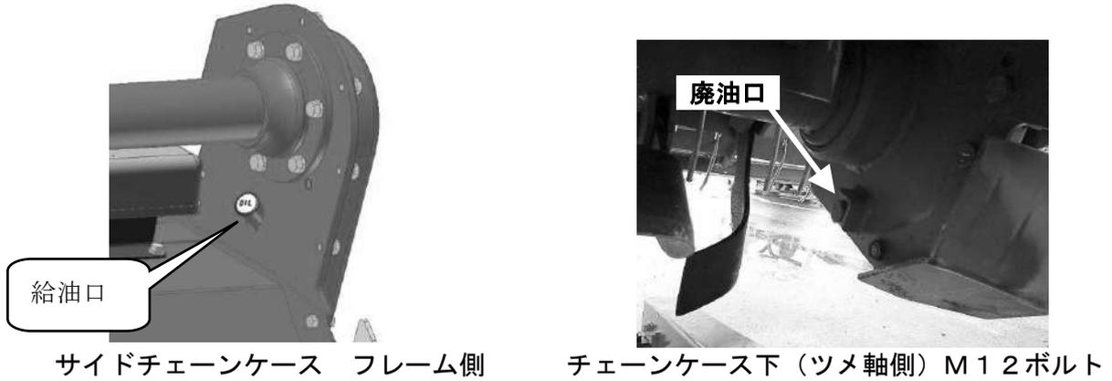
各軸受部には、上側に給油口と空気抜き口の2ヶ所、下側に廃油口の1ヶ所 M8ボルトとシールワッシャで締めこんでいます。ラチェットのソケット (二面幅12のサイズ) で廃油口に予め廃油ケースを置いてからの廃油口ボルトを外し、つぎに給油口と空気抜き口のボルトを外してください。廃油が終わり給油するときは、下側廃油口にシールワッシャとM8ボルトで締め込み、上側の給油口からオイラー (給油注し; 約200ccサイズ) で指定量を給油してください。給油が終わりましたら、給油口と空気抜き口をM8ボルトとシールワッシャ (2ヶ所) で締めこんでください。
