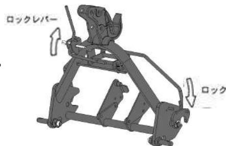
6. 3Sの場合は、本機がトラクタに装着された後にエンジンを停止し、ユニバーサルジョイントを装着してください。広角側をトラクタPTO軸へ取り付けてください。トラクタ側、作業機側ともにノックピンが正確に軸溝に、はまっているか確認してください。
