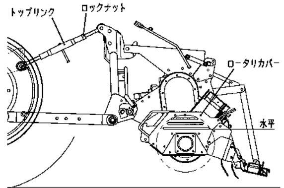
**参考** トップリンクの調整は、3点リンクを下げて、本機を一旦地面に下ろすと、調整しやすいです。
