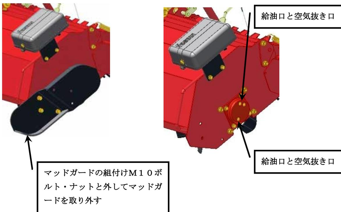
6) 注油箇所は、折りたたみ支点とレール・ローラ、ユニバーサルジョイント、ローターエンド、油圧シリンダです。
