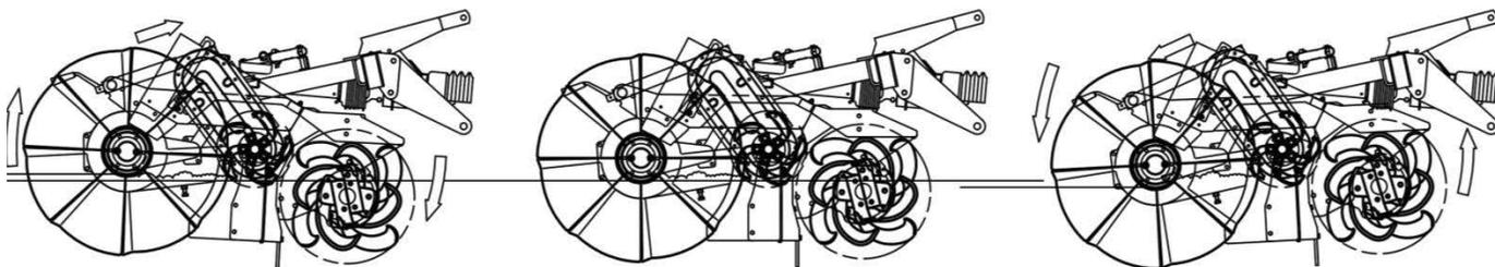
クランクハンドルを回転させると上面処理ロータリーを中心にロータリー、ノリ面ディスクが連動して回転します。地面とロータリーカバーが水平になることが標準ですが、土の状態やあぜ高さによって仕上がりが異なりますので姿勢を調整してご使用ください。
