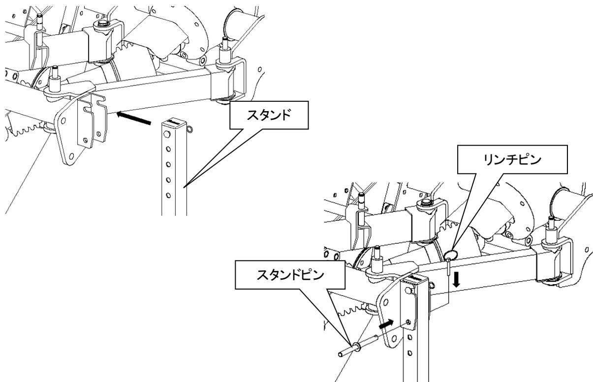
※スタンド装着後、トラクタから脱着できない場合はスタンド取り付けピンの穴位置を脱着がスムーズに行える位置へ変更してください。
