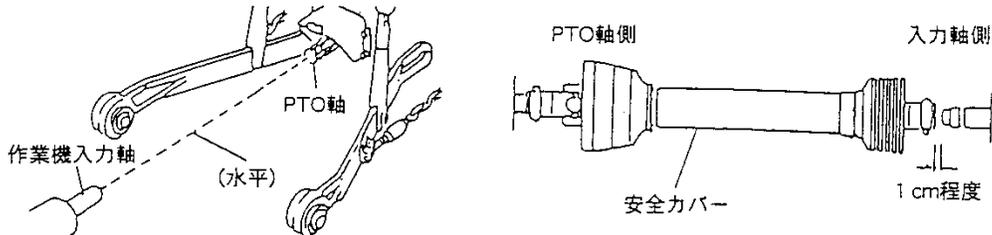
また、ジョイントのオス・メスを外して、それぞれPTO軸と入力軸に取り付け、水平で一直線上にあたる時(最縮時)に、下図のスキマが25mm以上あり、作業機を上下させてジョイントが一番伸びた時(最伸時)に、オス・メスの重なりが100mm以上あると、適正長さの範囲です。
