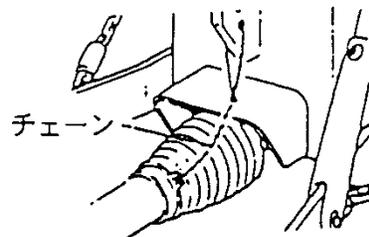
8) 本機を持ち上げた状態で、PTO軸とジョイントと作業機入力軸が一直線になるよう左右のチェックチェーンを均等に張ってください。その後ターンバックルを0.5~1回転戻しロックしてください。
