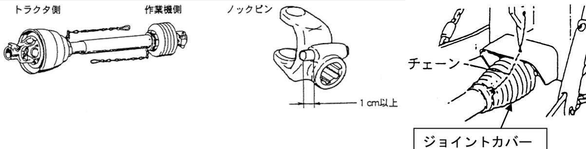
※トラクタによってはユニバーサルジョイントの長さが合わない場合があります。必ず適正長さの範囲内で使用してください。短すぎるとジョイントが抜けて思わぬ事故につながり、長すぎると機械を破損してしまいます。短い場合は交換し、長い場合は切断し使用してください。
