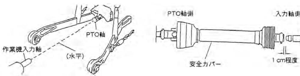
また、ジョイントのオス・メスを外して、それぞれPTO軸と入力軸に取り付け、水平で一直線上にある時（最縮時）に、下図のスキマが25mm以上あり、作業機を上下させてジョイントが一番伸びた時（最伸時）に、オス・メスの重なりが100mm以上あると適正長さの範囲です。
