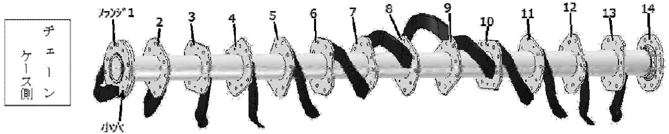
フランジ2～13にL爪をR爪の回転方向側（機体後方からみて前側）につけます。
