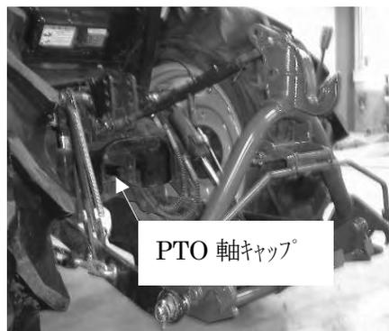
2. トップリンクをトラクタ後部のブラケットの一番下の穴にピンで取り付けてください。
