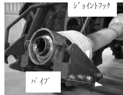
7、操作レバーを矢印（→）の方向に倒し、フックプレートを図のようにロック状態にします。
