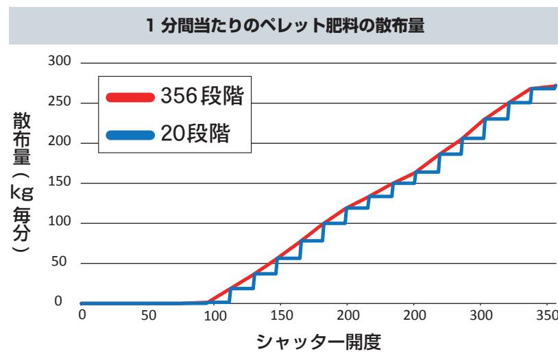
シャッター開度に応じて散布量のグラフがなだらかな線状の変化を示しており、バラつきが生じやすい有機ペレットでも精密な散布を実現します。
