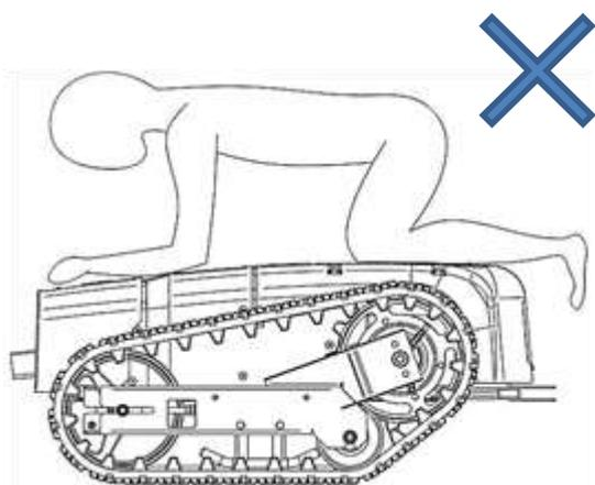
本機のみで角度のある斜面の走行は行わないでください。本機のみであゆみ板などの斜面を走らなくてはならない状況では必ず後進で30度以下の面を走行してください。前進で走ると機体前部分が浮き上がり危険です。機体前部分が浮き上がった場合は機体の後ろ側には絶対に立たないでください。側面側から浮き上がりを抑え安全な姿勢になるようにしてください。前進は15度以下の面を走行してください。また斜面走行時は速度は30%以下に設定し、急発進・急停止は行わないでください。
