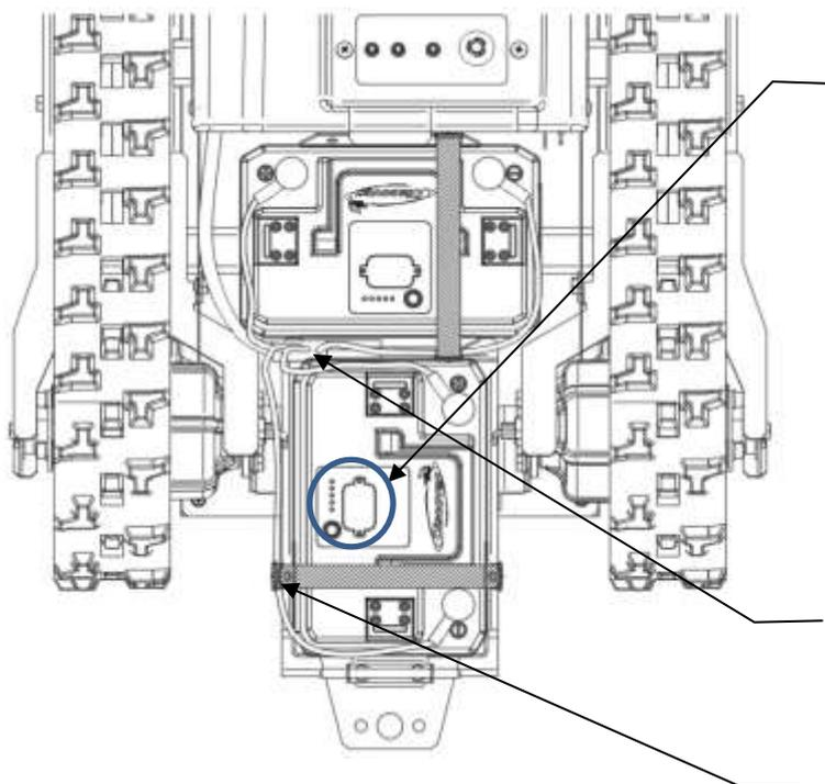
⑥ 電源スイッチ部(丸で囲んである部分)が機体左側に位置する向きで機体後側のバッテリーを乗せてください。
