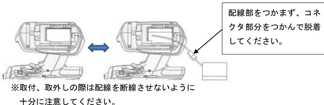
(3) バッテリーの取付け及び取り外し後はコントローラの下部カバーを必ず付けてください。
