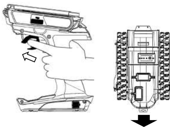
トリガーの引き(押し)具合で速度を微調整することができます。
