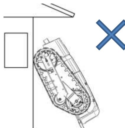
機体を駐車するときは平坦な場所に止め、コントローラの電源スイッチを切り、バッテリーの電源スイッチを2~3秒長押しして「OFF」にしてください。
