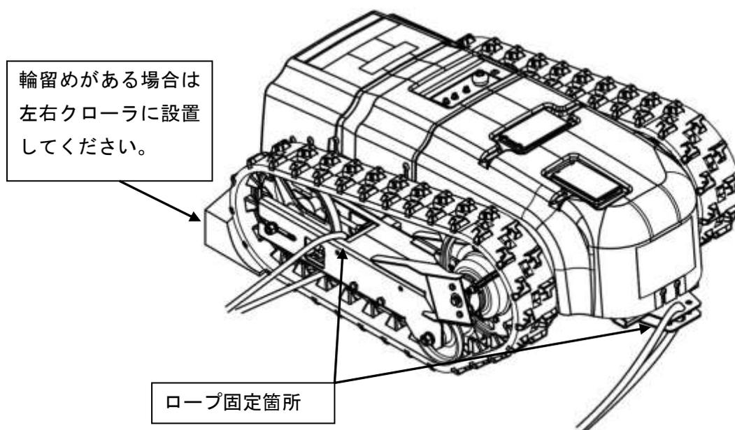
※ロープによる固定は過度な力をかけない様にしてください。機体が遊ばなくなる程度の力で固定するようお願いします。
