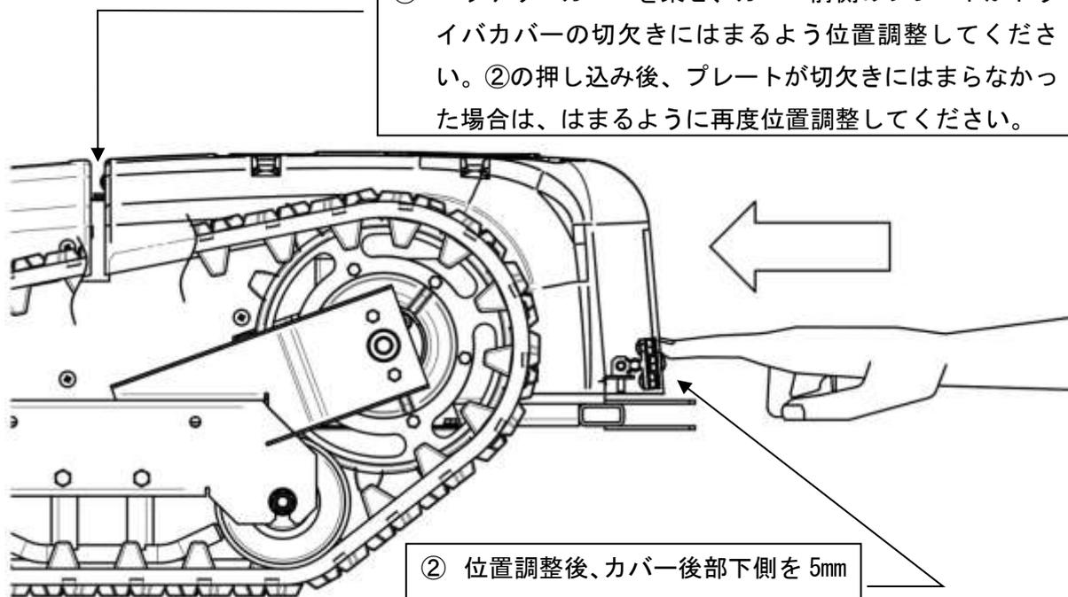
① バッテリーカバーを乗せ、カバー前側のプレートがドライバカバーの切欠きにはまるよう位置調整してください。②の押し込み後、プレートが切欠きにはまらなかった場合は、はまるように再度位置調整してください。
