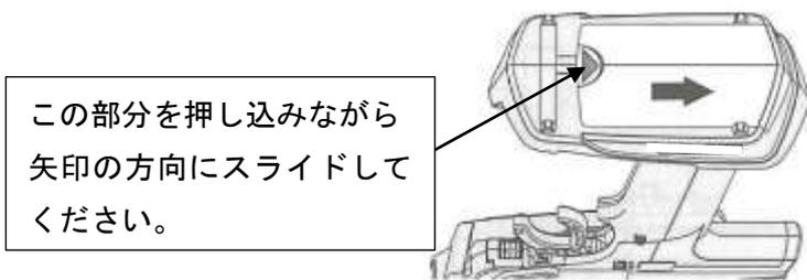
(2) 取外し：バッテリーを外し、コネクタ部をつかんでバッテリーとコントローラを切り離してください。
