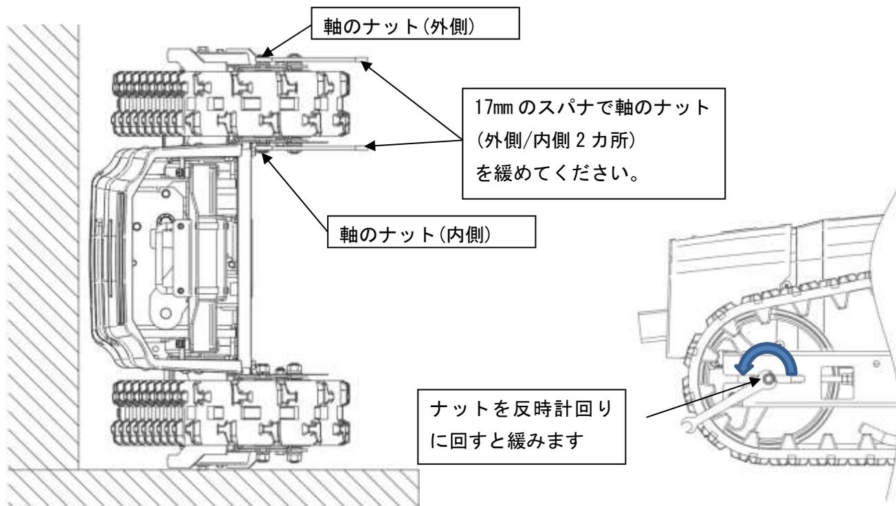
【B】 軸のナットを緩めたら 2 本の 14mm レンチを使い固定ナットを緩めテンションナットを調整しクローラの張りを調整してください。テンションナットは内側と外側で同じ量締めてください（下の図は外側の図です）。片側だけ調整するとホイールの軸が斜めになり、クローラの外れやクローラの山とホイールの干渉による異音、フレームの変形の原因となります。
