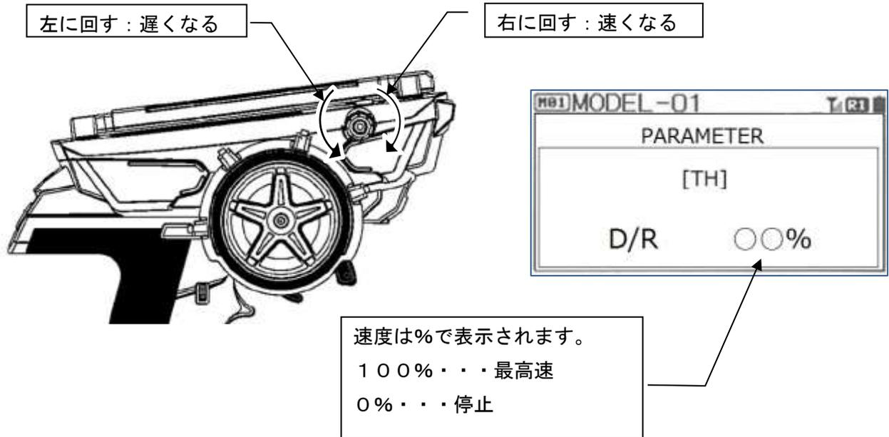
※刈刃ユニット(別売)を装着し、刈刃回転スイッチを操作すると最高速度は 50% に規制されます。
