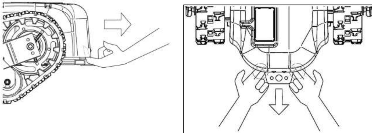
バッテリーカバーを外し、本体から出ている電源ハーネスを挟み込まないようにバッテリーを配置してください。バッテリーは前側・後側と 2 カ所置くことができ、最大 2 個のバッテリーを搭載できます。
