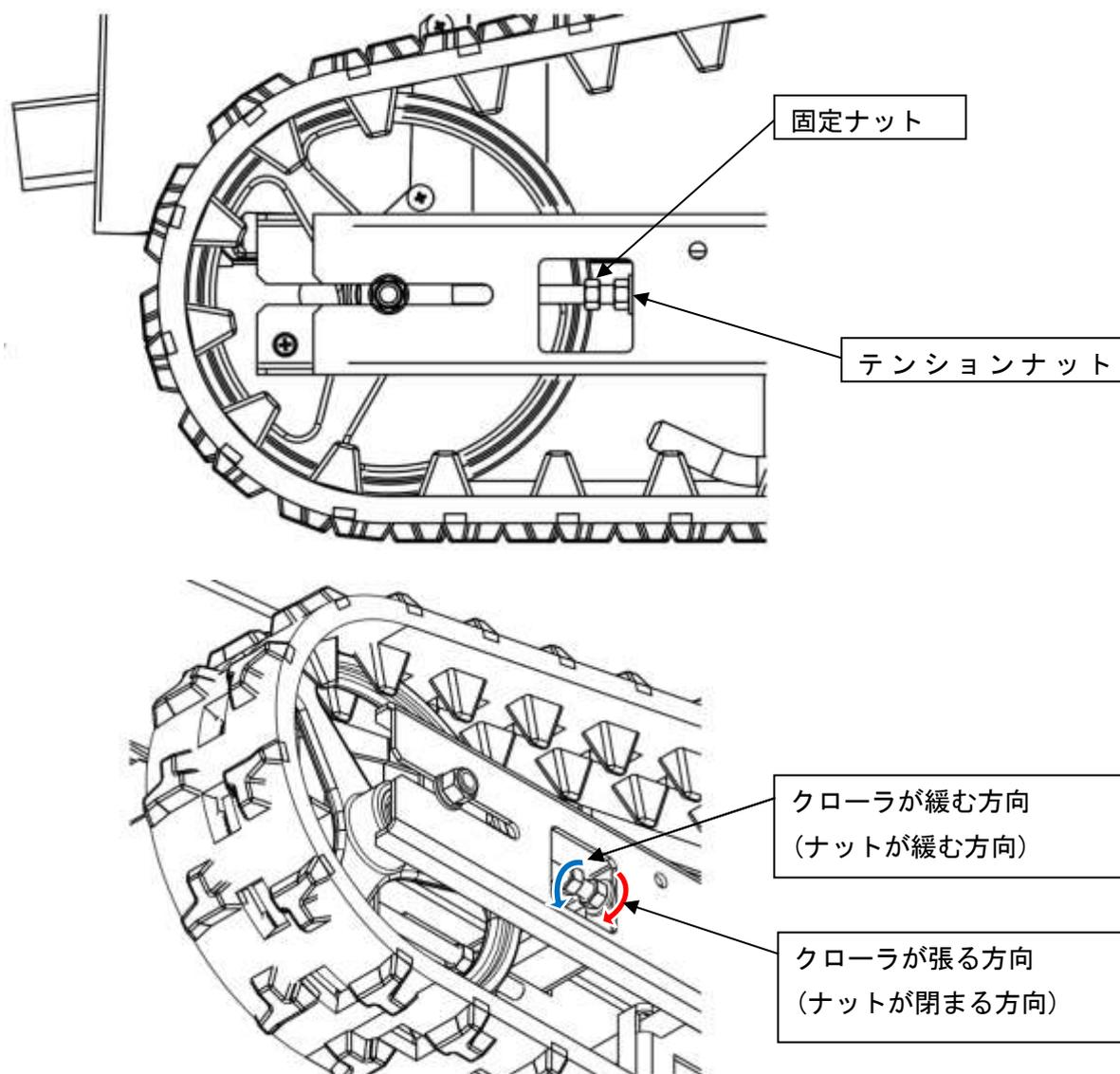
【C】 テンションナットを調整しクローラのたわみが規定値内に入ったら、一本の 14mm レンチでテンションナットを動かないようつかみ、もう一本の 14mm レンチで固定用ナットを締め付けテンションナットが動かない様にしっかりと固定して下さい。内側と外側どちらも確実に固定して下さい
