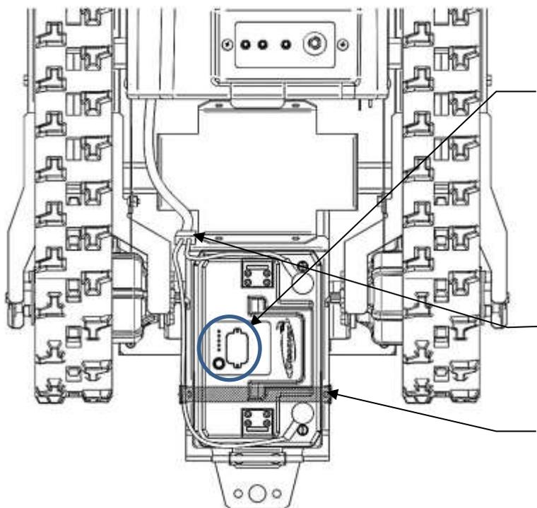
① 電源スイッチ部(丸で囲んである部分)が機体左側に位置する向きでバッテリーを乗せてください。
