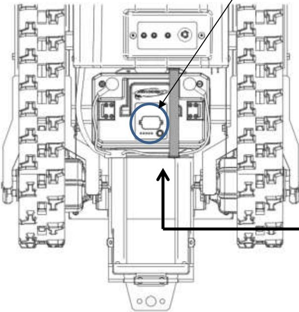
③ 電源スイッチ部(丸で囲んである部分)が機体後側に位置する向きで機体前側からバッテリーを乗せてください。
